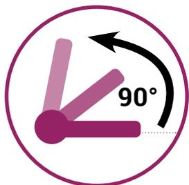
Votre porte est verrouillée par relevage de la béquille (poignée de la porte). Ce mouvement engage les galets, pannes ou pènes massifs et le pêne dormant.
