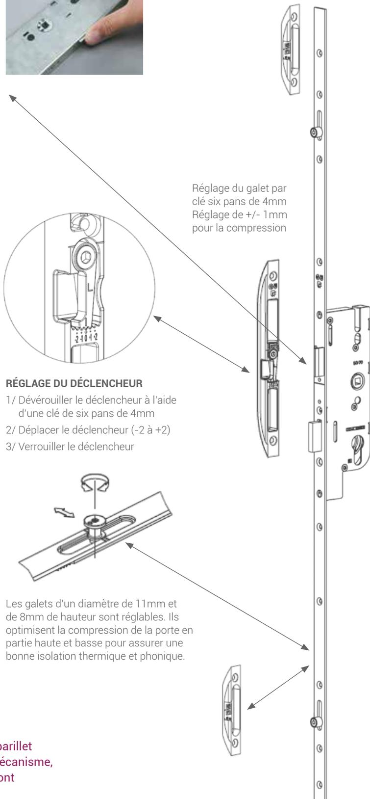
**Recommandation :** Le verrouillage au moins quotidien du barillet (notamment la nuit) permettra de détendre le ressort du mécanisme, de préserver son efficacité et de s'assurer que les galets sont entièrement engagés à l'intérieur des gâches.
