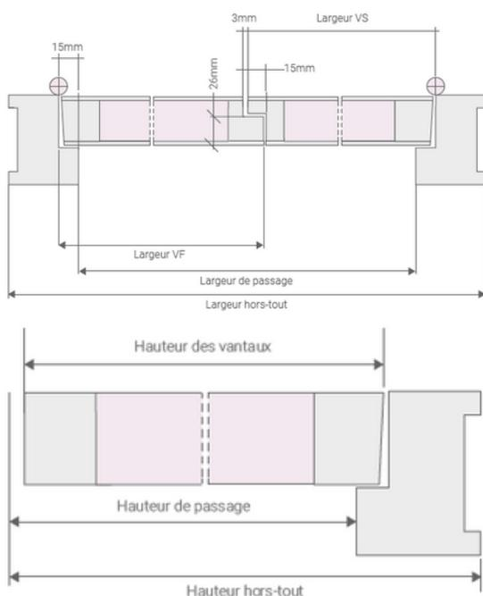
**BLOC PORTE À DOUBLE VANTAUX DÉGRAISSÉS À FEUILLURES DE BATTEMENT\***
